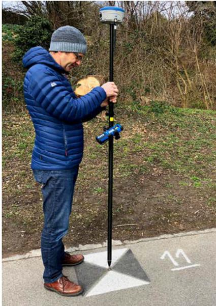
Abb. 3: Aufnahme der Passpunkte.
