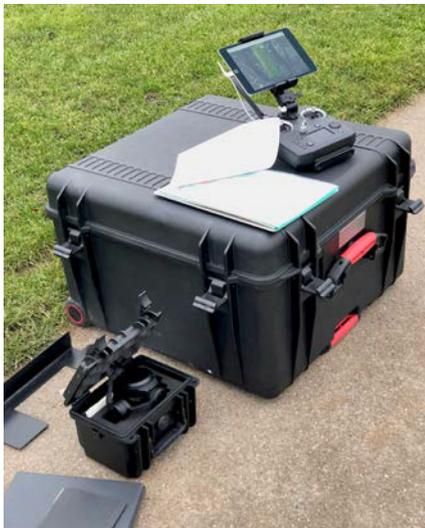
Abb. 4: Drohnen-Koffer mit Controller und Tablet.
